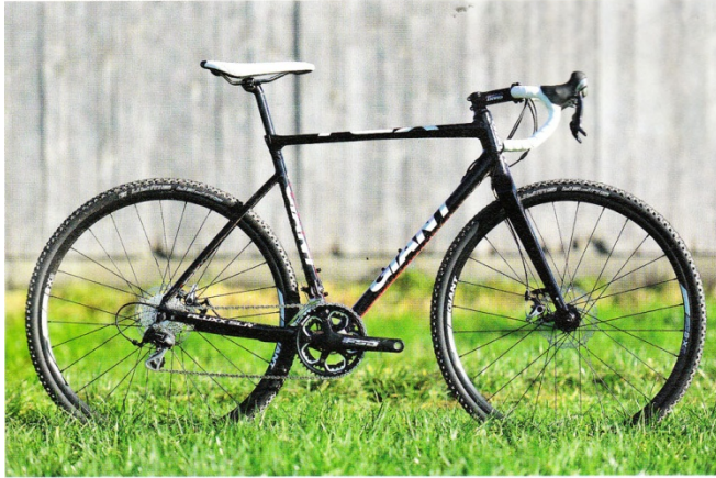
Im Zickzack geht das Oberrohr in den Hinterbau über.
